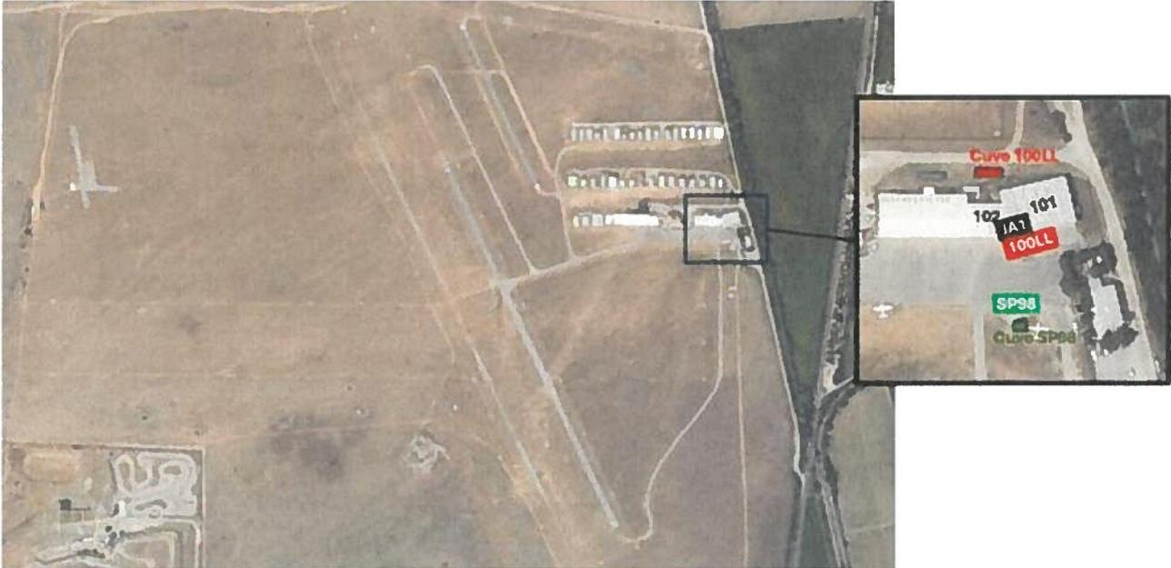
[1] La station de JetA1 appartient à l'ACRL, utilisateur exclusif de ce type de carburant pour ses deux DA40D. Elle comprend une cuve hors-sol de 2500 litres placée dans le hangar 101 et un distributeur placé dans le local indépendant (accès par l'extérieur) situé entre les hangars 101 et 102.
